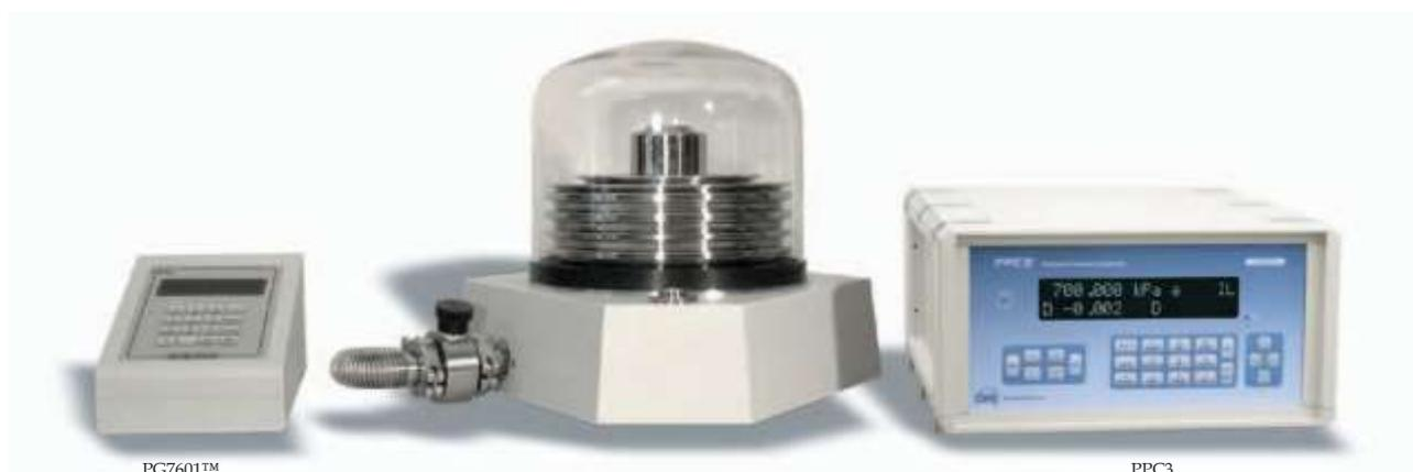
PG7601 推荐用于覆盖气体绝压和表压，包括接近和低于大气压的压力。PG7601 通过将砝码的钟形罩抽为真空，以真空为参考进行测量。如果不需要接近或低于大气压的绝压和表压以及/或者需要高于 7 MPa (1 000 psi) 的压力，应考虑使用 PG7202，该平台不具备真空参考能力。
