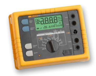
如果只有一条路径接地,如在许 多住宅应用中,无接地棒测试方 法将无法提供可接受的值,必须 使用电位降测试方法。
